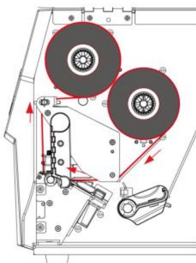
碳带前缘经碳带轴杆，通过印表头固定在碳带回收轴上，即完成碳带的安装。
