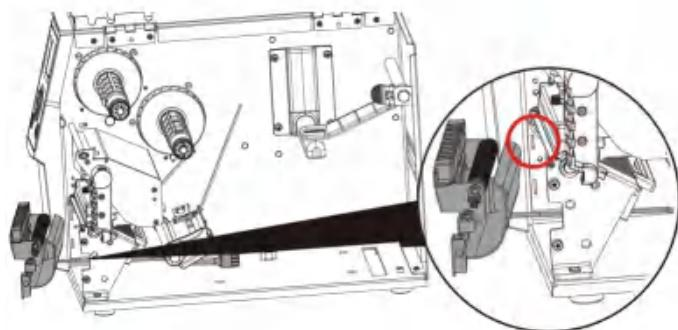
5. 将自动剥纸器模组右侧卡榫卡入机器凹槽内 ·
