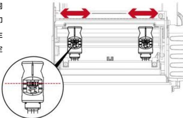
如调整印表头弹簧固定盒位置后，情况仍未改善时，请利用一字起子将弹簧固定盒的调整螺丝，往左方向加强压力，往右方向减弱压力。
