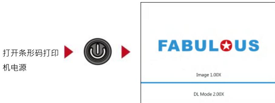
条形码打印机启动后，LCD 屏幕上会出现“就绪”讯息，表示条形码打印机是在准备打印的状态。
