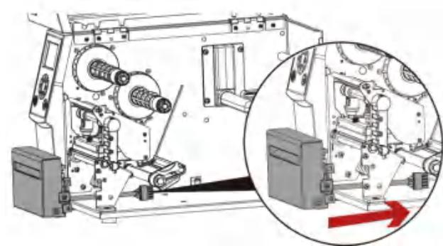
4. 依据箭头方向将裁刀连接线穿过滚轮支架
