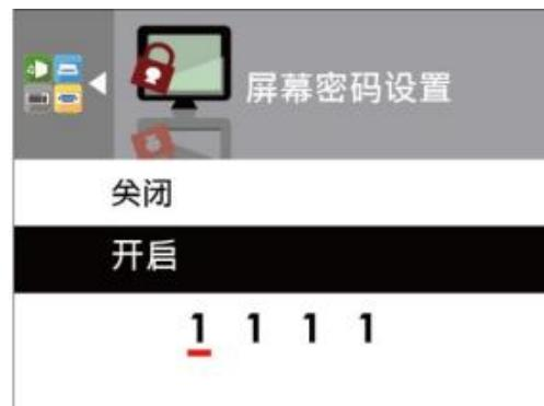
设定完成，请务必确实按两次走纸键，让画面回到屏幕密码的设定画面。
