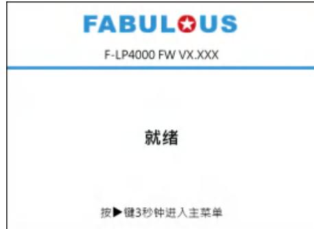
请按住 ▶ 按钮，待 LCD 屏幕上的定时器到数完成后，即可进入设定模式的主画面。您可以从此主画面开始，针对条形码打印机作各种不同的设定操作。
