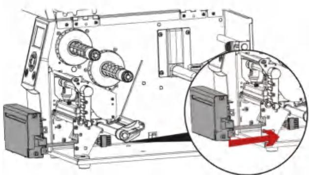
4. 依据箭头方向将裁刀连接线穿过滚轮支架
