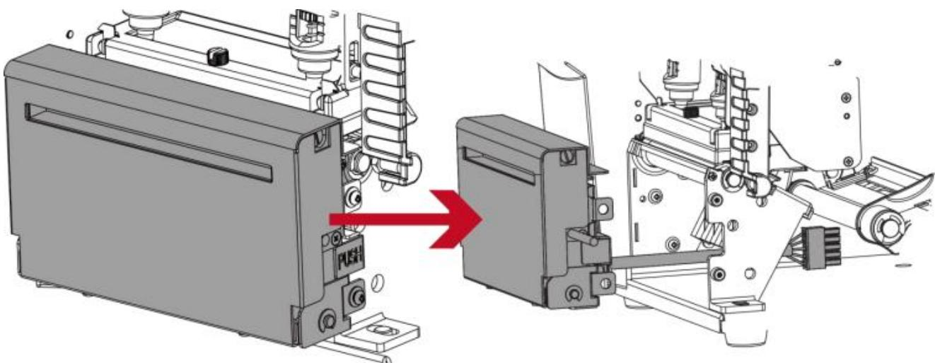
当卡纸而造成裁刀无法正常使用时·请先关闭电源
