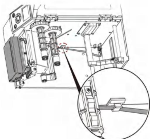
7. 将裁刀连接线置入集线器内，如下图所示
