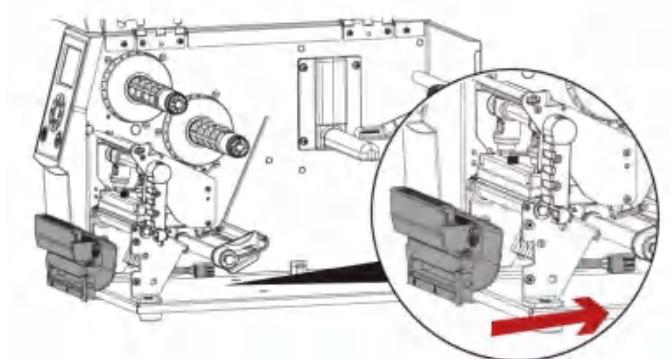
4. 依据箭头方向将自动剥纸器连接线穿过滚轮
