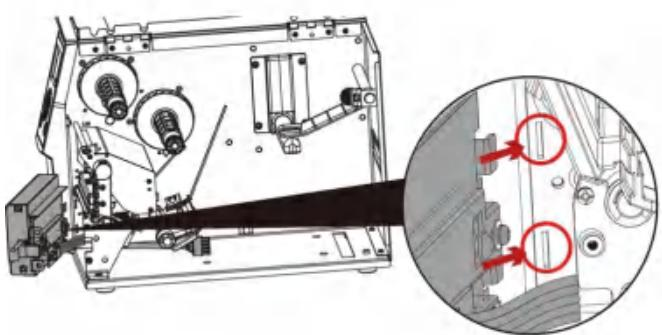
5. 将旋刀模组右侧卡榫卡入机器凹槽内
