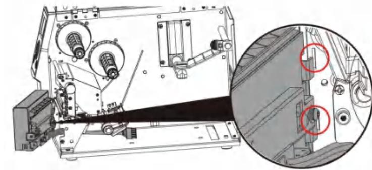
5. 将铡刀模组右侧卡榫卡入机器凹槽内 ·
