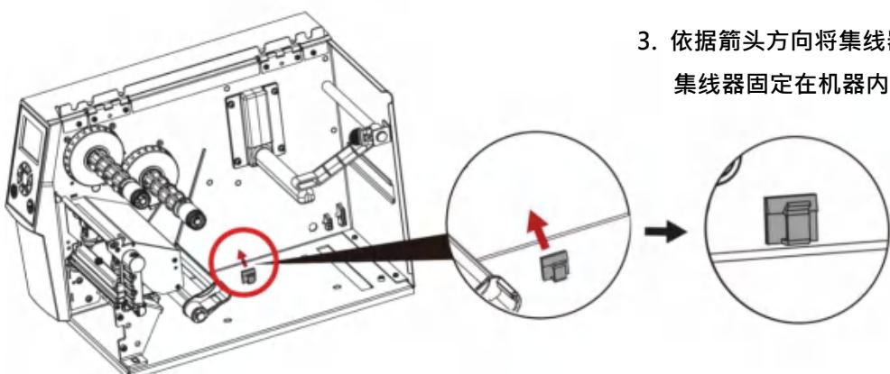
3. 依据箭头方向将集线器的背胶底纸撕除并将
