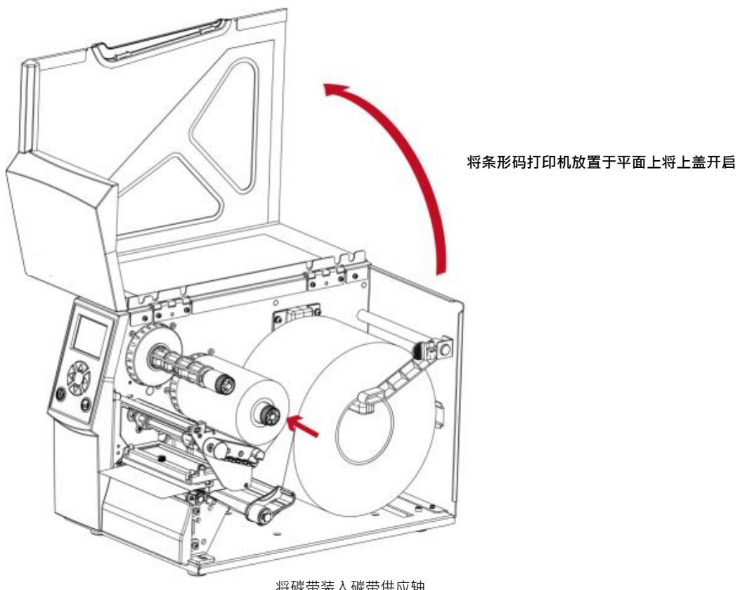
将条形码打印机放置于平面上将上盖开启
