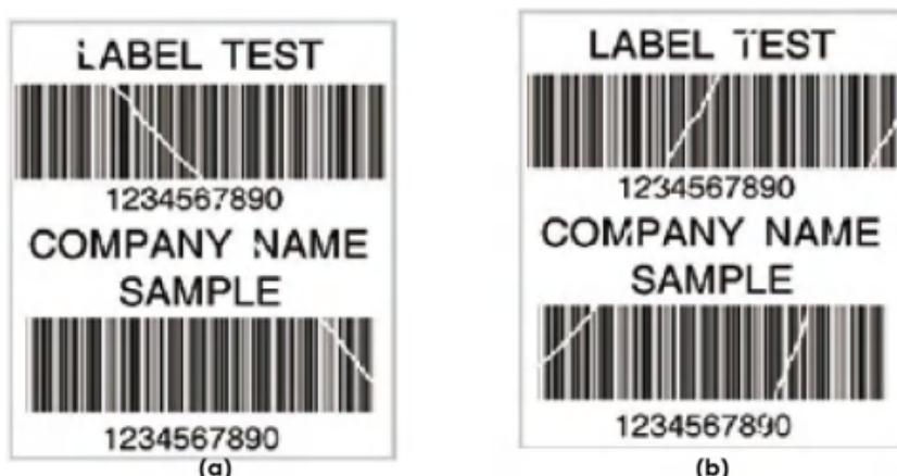
调整圈数每次以半圈为一个单位调整，调整后请再作打印测试，如碳带皱折未改善，请依上述方式再作调整，而调整圈数不得超过 2 圈(即调整次数为 4 次)。
