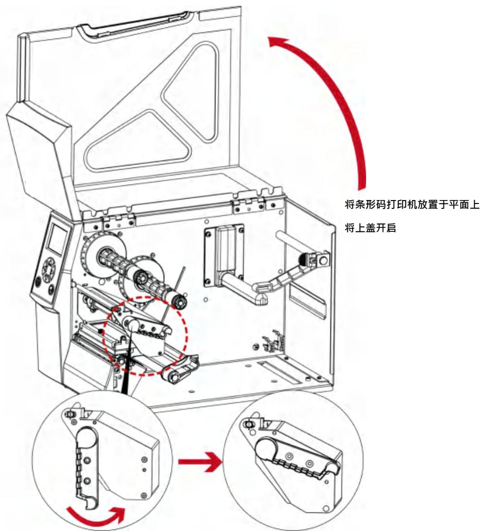
依照图目标顺序及方向，接着由后向上扳起。
