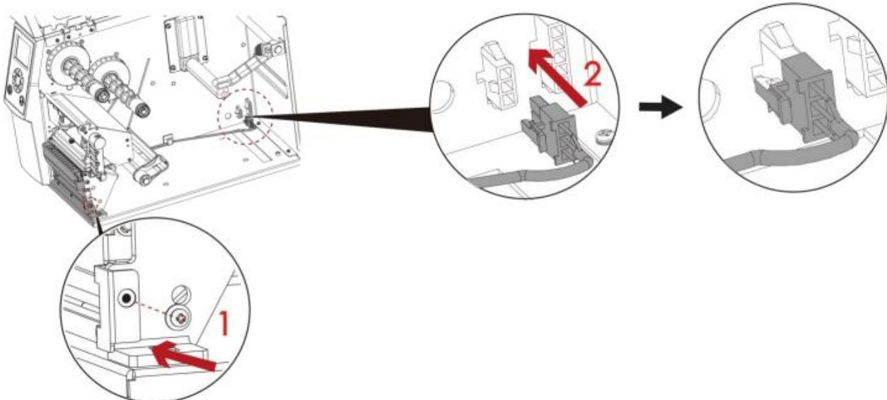
7. 将自动剥纸器连接线置入集线器内，如下图所示
