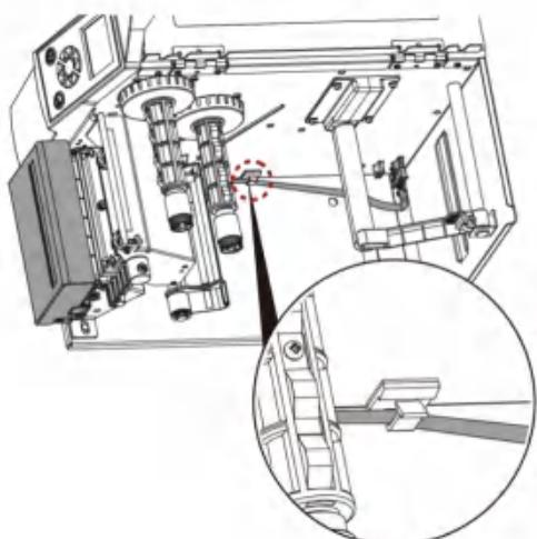
7. 将裁刀连接线置入集线器内，如下图所示
